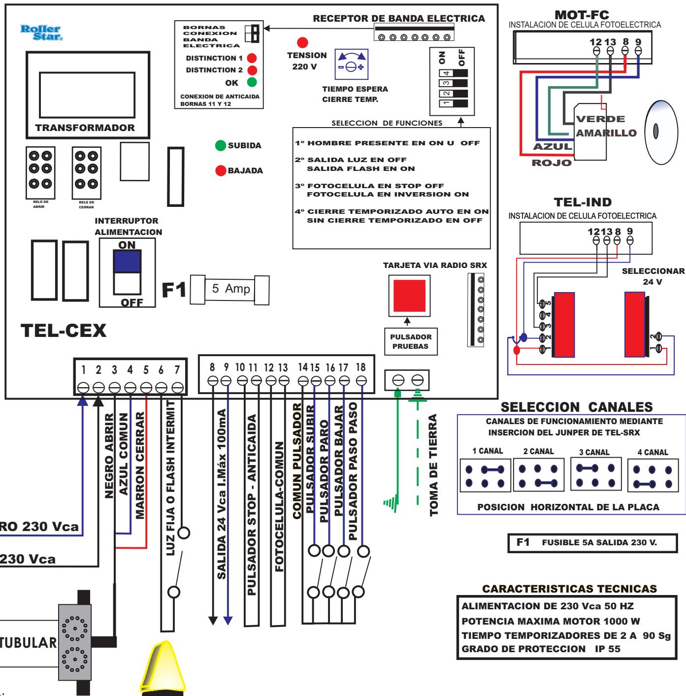
SI NO SE UTILIZARA ANTENA EXTERIOR OPCIONAL, CONECTAR UN HILO DE COBRE DE 1,5 SECCION X 15 CM DE LONGITUD EN EL BORNE DE VIVO N° A DE LA TARJETA Sr1
